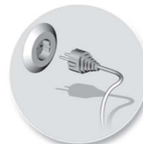
8 – питающий электрический шнур с евровилкой (вилкой с заземляющим контактом)
