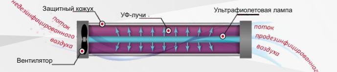
Рециркуляторы являются облучателями закрытого типа, в которых бактерицидный поток от ультрафиолетовой лампы распределяется в небольшом замкнутом пространстве.
