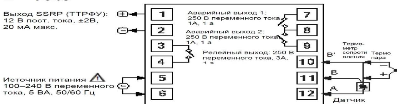
Рис. 9. Электрическая схема температурного контроллера.
