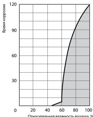
Из графика следует, что скорость коррозии незначительна при относительной влажности воздуха менее 50%, а при влажности воздуха менее 40%, скоростью коррозии вообще можно пренебречь. Но когда относительная влажность воздуха превышает 60%, скорость коррозии значительно увеличивается.
