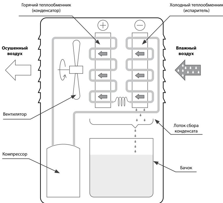
При работе с использованием внутреннего бака, при его наполнении конденсатом, осушитель отключается и на табло панели управления загорается индикатор заполнения бака «FULL». Для дальнейшей работы осушителя необходимо извлечь внутренний бак, освободить его от воды и установить назад в осушитель (заливной шланг должен быть помещен в заливное отверстие бака). Индикатор «FULL» при этом должен погаснуть.
