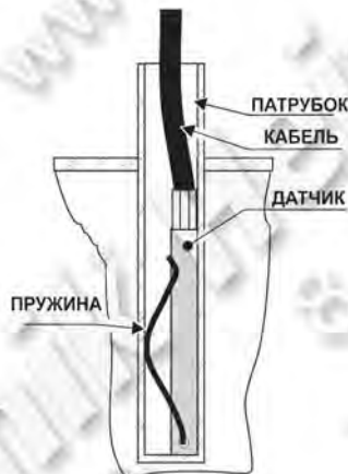
Монтаж датчика котла
